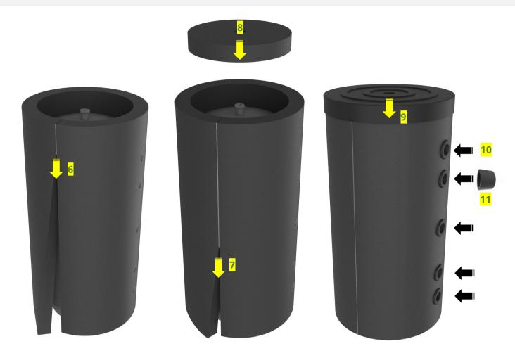
Den Reißverschluss oben einhängen (6) und, während die zweite Person die Teile zusammenhält, Stück für Stück nach unten ziehen (7). Eventuell kann es notwendig sein die Dämmung nochmals durch vorsichtiges Ziehen und Klopfen mit der flachen Hand straff an den Energiespeicher ES anzulegen.
