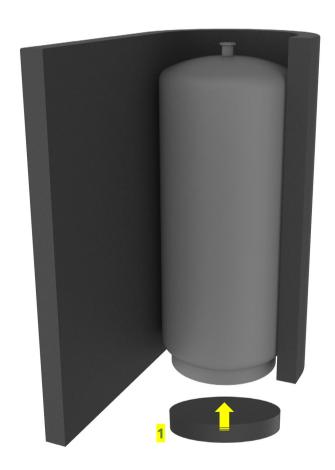
Die untere Dämmung am Boden des Energiespeichers ES anbringen (1). Die Dämmung bei den Muffen (2-5) einhängen, festhalten und kräftig an den Energiespeicher ES andrücken. Anschließend die Dämmung, wie auf der Zeichnung dargestellt, spannen und straff um den Energiespeicher ES legen. Unbedingt darauf achten, dass zwischen Dämmung und Energiespeicher ES kein Zwischenraum ist. Falls nötig, die Dämmung durch Drücken und Klopfen mit der flachen Hand straffen.
