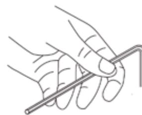
Um das Ballorex Delta anders einzustellen, den Innensechskantschlüssel gegen den Uhrzeigersinn drehen, bis der Endpunkt erreicht und die Feder völlig entspannt ist. Ab diesem Punkt den Innensechskantschlüssel im Uhrzeigersinn um die Anzahl an Drehungen drehen, die in den obigen Tabellen der erforderlichen  $\Delta P$ -Einstellung entspricht. Die Differenzdruckeinstellung erfolgt mit einem 4-mm-Innensechskantschlüssel.
