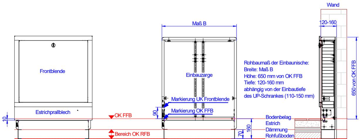
Fußbodenaufbau vom Rohfußboden 90-160 mm, bei Fußbodenaufbau > 160 mm ist eine zusätzliche bauseitige Aufbaukonstruktion nötig
