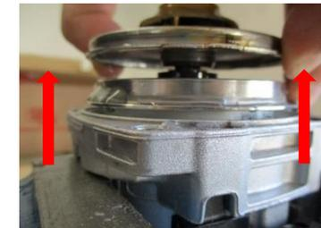
6 Lagerplatte mit Laufrad festhalten und dann den Rotor händisch (frei) drehen
