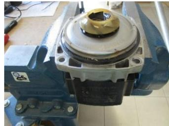
4 EPDM-Dichtung vom Spaltrohrtopf entfernen
