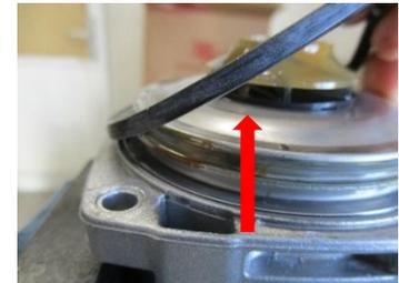
5 Lagerplatte an den Einkerbungen vorsichtig und gleichmäßig nach oben von dem Spaltrohrtopf abhebeln
