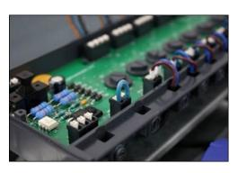
Die Klemme HKF ermöglicht durch Anschluss eines externen Temperatur- oder Taupunktsensors als Öffner- Kontakt das Abschalten und damit Schließen der Stellantriebe als Schutzfunktion gegen Überhitzung oder Tauwasserbildung.
