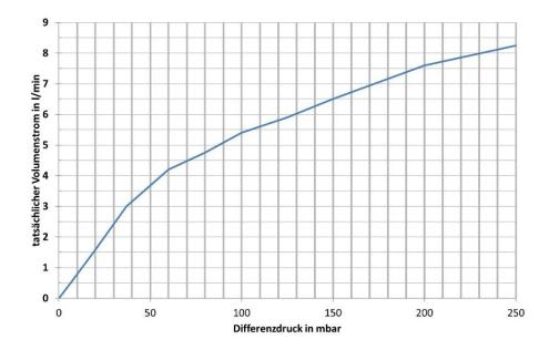
Druckverlust Thermostatventileinsatz VA (kvs = 2,56 m³/h)
