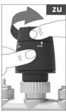
Die Stellungsanzeige im stromlos geschlossenen (NC) Zustand ermöglicht eine unkomplizierte Funktionsprüfung, beispielsweise bei der Montage des Stellantriebs auf Heizkreisverteilern. Sobald die Betriebsspannung angelegt wird, beginnt das Ausdehnungssystem des Stellantriebs zu erwärmen. Nach Ablauf der Totzeit öffnet sich das Ventil gleichmäßig. Bei einer Spannungsunterbrechung schließt der Stellantrieb wiederum nach der Totzeit durch die Abkühlung des Ausdehnungssystems.
