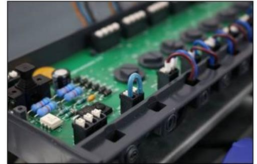
Die Klemme HKF ermöglicht durch Anschluss eines externen Temperatur- oder Taupunktsensors als Öffner- Kontakt das Abschalten und damit Schließen der Stellantriebe als Schutzfunktion gegen Überhitzung oder Tauwasserbildung.
