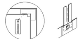
Den UP-Schrank mittels der höhenverstellbaren Füße auf die Höhe der Oberkante des Fertigfußbodens (OK FFB) einstellen, so dass sich die Markierung OK FFB an der Einbauzarge des UP-Schranks auf Höhe der Oberkante des Fertigfußbodens (OK FFB) befindet. Die bauseitige Höhe der Sockelleiste darf maximal 80 mm betragen. Zur sicheren Fixierung sind die höhenverstellbaren Füße auf dem Rohfußboden zu befestigen. Der Verteilerschrank kann zusätzlich an der Rückwand der Einbauzarge befestigt werden.
