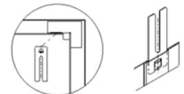
Den UP-Schrank mittels der höhenverstellbaren Füße auf die Höhe der Oberkante des Fertigfußbodens (OK FFB) einstellen, so dass sich die Markierung OK FFB an der Einbauzarge des UP-Schranks auf Höhe der Oberkante des Fertigfußbodens (OK FFB) befindet. Die bauseitige Höhe der Sockelleiste darf maximal 80 mm betragen. Zur sicheren Fixierung sind die höhenverstellbaren Füße auf dem Rohfußboden zu befestigen. Der Verteilerschrank kann zusätzlich an der Rückwand der Einbauzarge befestigt werden.
