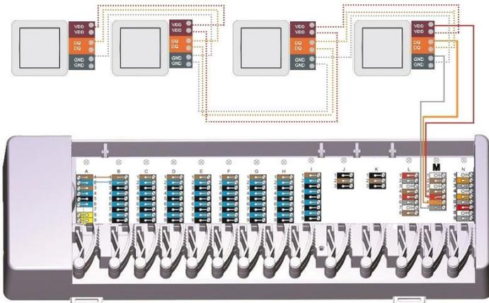
Beispiel 2: Baumstruktur. Von einer Hauptleitung führen mehrere Stichleitungen zu den einzelnen Sensoren.
