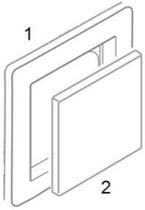
1. 55 mm Einsatz (2) passend zum Montagerahmen (1) ausrichten
