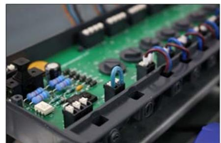
Die Klemme HKF ermöglicht durch Anschluss eines externen Temperatur- oder Taupunktssensors als Öffner-Kontakt das Abschalten und damit Schließen der Stellantriebe als Schutzfunktion gegen Überhitzung oder Tauwasserbildung.
