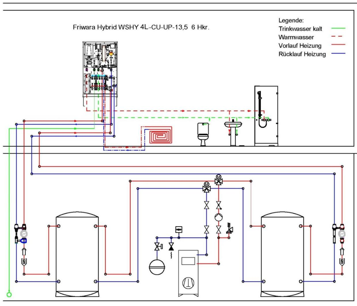
Der linke Pufferspeicher dient der Warmwasserbereitung.
