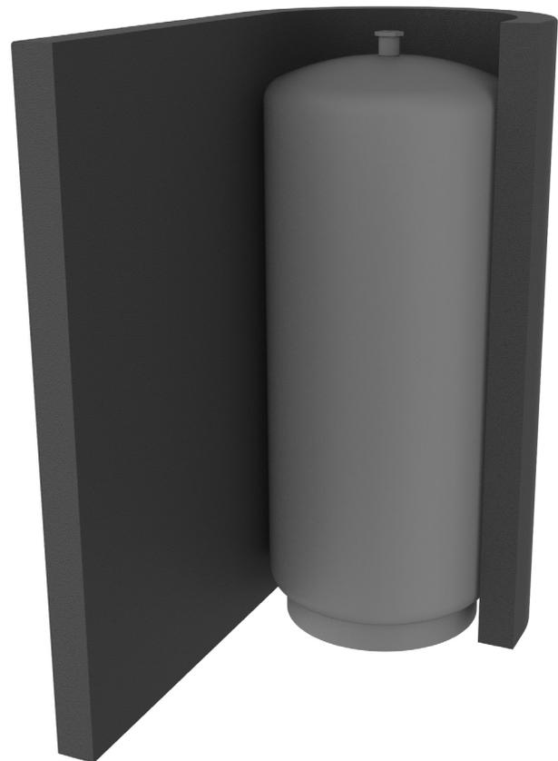
Die Dämmung bei den Muffen (1-4) einhängen, festhalten und kräftig an den Energiespeicher ES andrücken. Anschließend die Dämmung, wie auf der Zeichnung dargestellt, spannen und straff um den Energiespeicher ES legen. Unbedingt darauf achten, dass zwischen Dämmung und Energiespeicher ES kein Zwischenraum ist. Falls nötig, die Dämmung durch Drücken und Klopfen mit der flachen Hand straffen.
