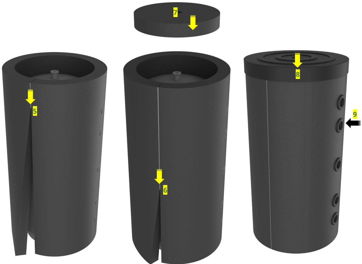
Den Reißverschluss (5) oben einhängen und, während die zweite Person die Teile zusammenhält, Stück für Stück nach unten ziehen (6). Eventuell kann es notwendig sein die Dämmung nochmals durch vorsichtiges Ziehen und Klopfen mit der flachen Hand straff an den Energiespeicher ES anzulegen.
