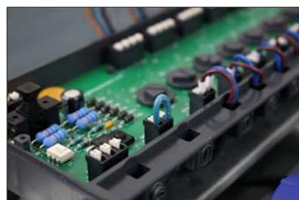
Die Klemme HKF ermöglicht durch Anschluss eines externen Temperatur- oder Taupunktssensors als Öffner-Kontakt das Abschalten und damit Schließen der Stellantriebe als Schutzfunktion gegen Überhitzung oder Tauwasserbildung.
