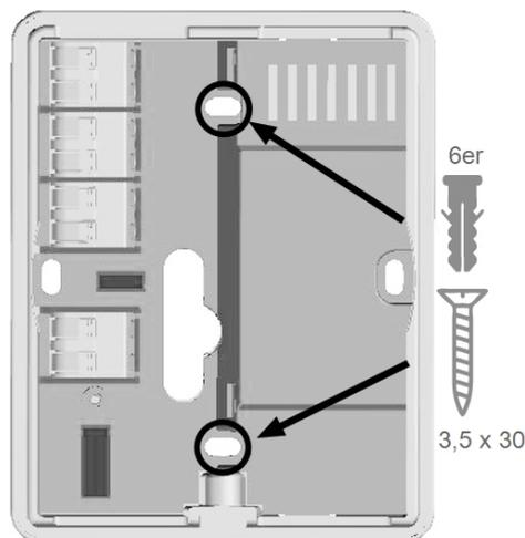
Montieren Sie das Gerät an geeigneter Stelle.
