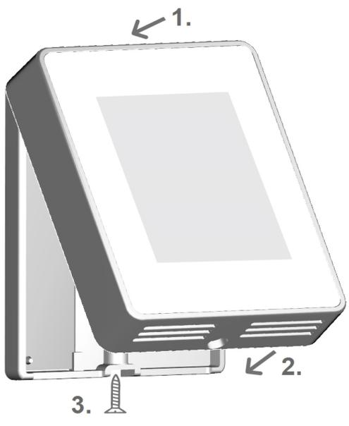
Das Bedienteil wieder einhängen und mit der Schraube verschließen. Netzspannung einschalten und strawaLiviX Raumcontroller Klima in Betrieb nehmen.
