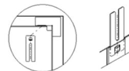
Den UP-Schrank mittels der höhenverstellbaren Füße auf die Höhe der Oberkante des Fertigfußbodens (OK FFB) einstellen, so dass sich die Markierung OK FFB an der Einbauzarge des UP-Schranks auf Höhe der Oberkante des Fertigfußbodens (OK FFB) befindet. Die bauseitige Höhe der Sockelleiste darf maximal 80 mm betragen. Zur sicheren Fixierung sind die höhenverstellbaren Füße auf dem Rohfußboden zu befestigen. Der Verteilerschrank kann zusätzlich an der Rückwand der Einbauzarge befestigt werden.
