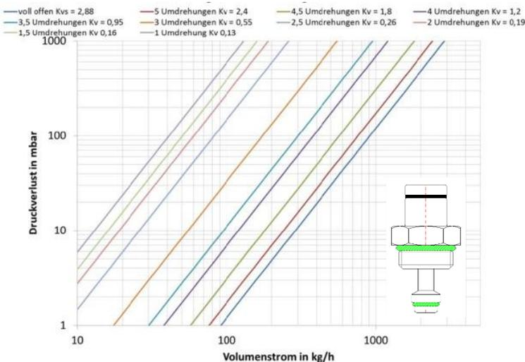
Thermostatventil VA (kvs = 2,56 m³/h)
