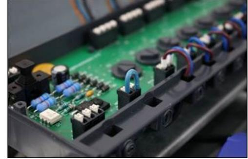
Vorgehensweise wie bei Raumthermostat. Empfohlene Länge zum Abisolieren mind. 15 cm. Bei flexiblem Pumpenkabel ist der Anschluss über die Kabeleinführung am Gehäuse analog zu den Stellantrieben zu nutzen (Bild).
