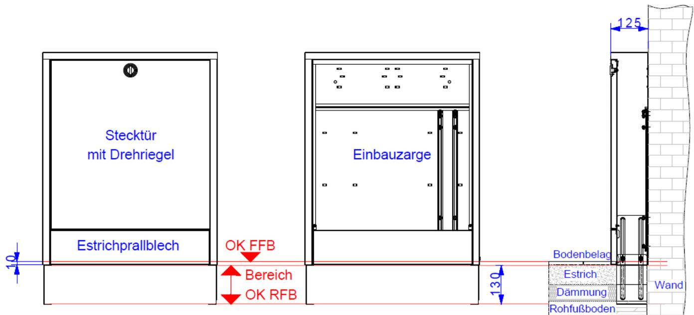
Den Aufputz-Schrank mittels höhenverstellbarer FüÙe auf die Höhe der Oberkante des Fertigfußbodens (OK FFB) einstellen, so dass sich das Estrichprallblech des Aufputzschrankes 10 mm unterhalb der Höhe Oberkante des Fertigfußbodens (OK FFB) befindet. Die bauseitige Höhe der Sockelleiste darf maximal 80 mm betragen. Zur sicheren Fixierung sind die höhenverstellbaren FüÙe auf dem Rohfußboden zu befestigen. Der Verteilerschrank kann zusätzlich an der Gehäuserückwand befestigt werden.
