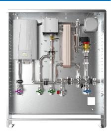
Durch die thermische Länge des Übertragers wird eine rasche Auskühlung und eine niedrige Rücklauftemperatur garantiert. Die Regelung der am Durchlauferhitzer vorgegebenen Warmwassertemperatur, erfolgt durch ein Zusammenspiel aus Volumenstromsensor, Temperaturfühlern, Durchlauferhitzer, Plattenwärmeübertrager und Umschaltventil. Der Heizungsvolumenstrom wird durch die zentrale primärseitige Pumpe bereitgestellt.
