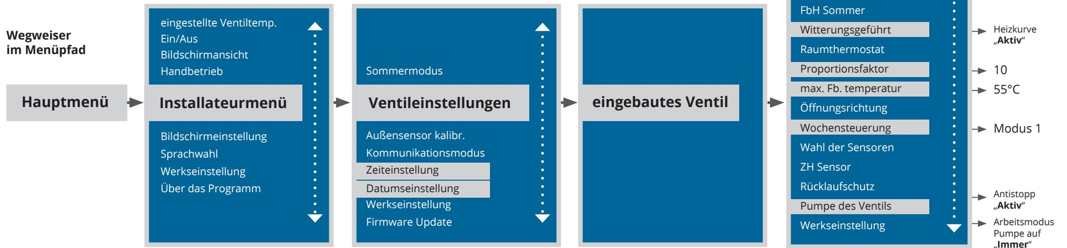
**Estrichtrocknung:** manuelle Temperatureingabe → Witterungsgeführt auf „Inaktiv“ → Wochensteuerung auf „Inaktiv“
