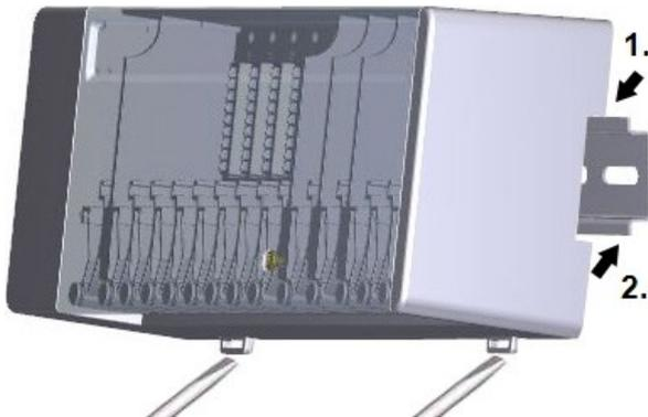
Hutschiene waagrecht mittels Schrauben an der Wand befestigen.
