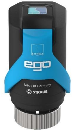
**Hinweis** Für die Funktion des EGO ist ein Zweipunkt-Raumtemperaturregler erforderlich. (Raumthermostate mit pulsierendem Signal sollen Schaltzyklen von mindestens 240 s aufweisen / EGO-Kompatibilitätsliste bei KNX-Aktoren beachten). Elektronisch geregelte Heiz- / Kühlkreisumpen sind, wie bei allen Flächenheizungen üblich, im Betriebsmodus  $\Delta p$ -c Konstantdruck zu betreiben.
