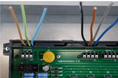
Die Reihenfolge der Raumthermostate ist dabei frei wählbar, da der Raum nachträglich zugeordnet werden kann. Bei nicht vollständiger Belegung mit 6 bzw. 8 Sensoren ist auch die Wahl der Anschlussklemmen frei.
