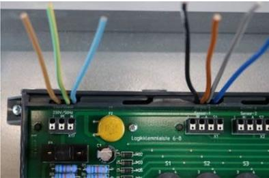
Äußere Isolierung des Kabels in ausreichender Länge abisolieren. Empfohlene Länge für 230 V-Spannungsversorgung und Sensoren ca.10 cm.
